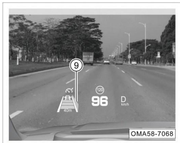
⑨ Faixa de advertência vermelha: alarme de detecção de ponto cego acionado
